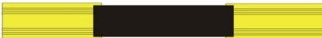
**Полученное соединение** должно быть полностью герметичным и не допускать контактов проводника сигнально – локализационной ленты с грунтом и влагой.
